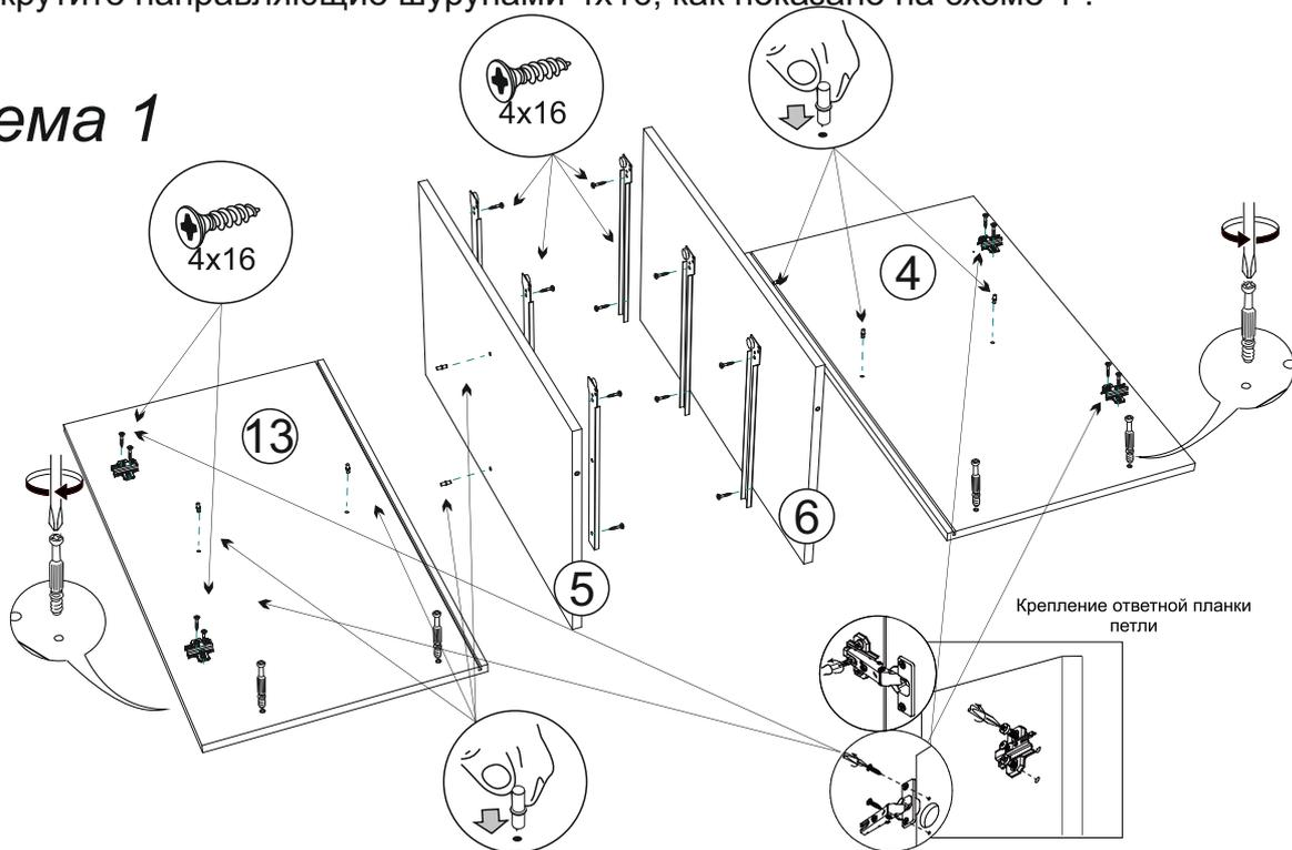
2. Соберите каркас Тумбы ТВ. Для этого соедините боковины №13,4 и перегородки №5,6 с вязкой №2 при помощи эксцентриковых стяжек и евровинтов. Закрепите опоры к вязке №2. Вставьте задние стенки (ЛДВП) №11 в пазы на боковинах и в паз вязки №2 соединив между собой брусом соединительным №1. Затем присоедините крышку №14 при помощи эксцентриковых стяжек как показано на схеме 2. Переверните Тумбу ТВ лицевой стороной вниз и проверив диагональ Тумбы ТВ, зафиксируйте ЛДВП уголками Rv8 и гвоздями.
